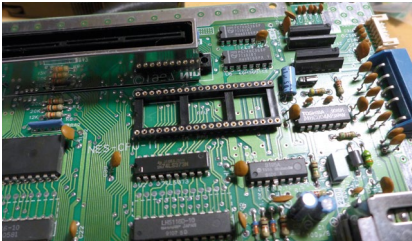
3. PPU:n irrotuksen jälkeen sen tilalle asennetaan piirikanta.
